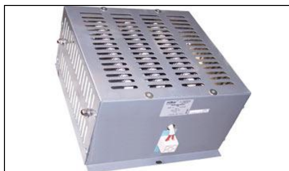
Brzdový odporník - maření elektrické energie při brždění vozidla, přepětová ochrana trakčního měniče
